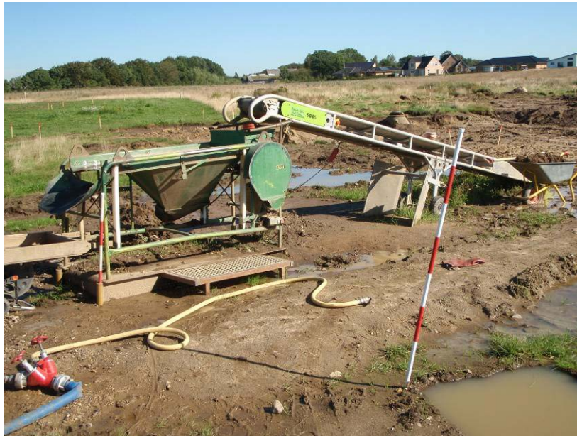
Soldemaskinen blev løbende brugt i Nedersøparken. Processen skal fornemmes fra højre mod venstre. Foto: M.E. Poulsen
