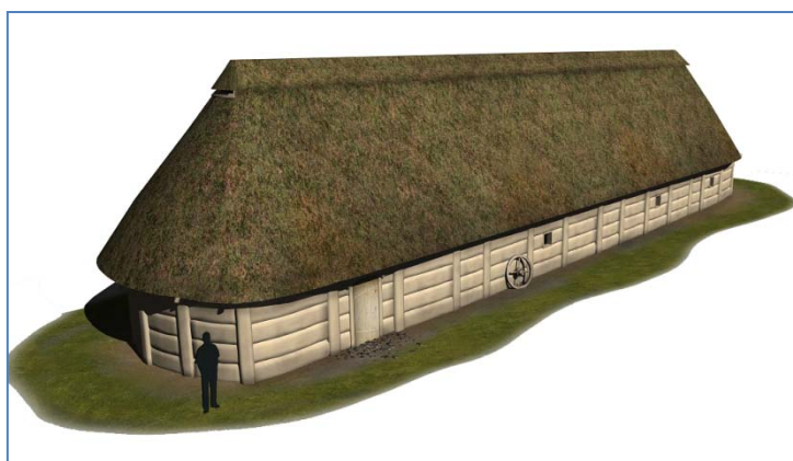
Figur 4: Omtrent således kan et langhus fra yngre romersk og ældre germansk jernalder have set ud. Bemærk de lodrette vægstolper med de mellemliggende vandrette planker. Opførelsen af huset krævede en stor mængde tømmerressourcer. Rekonstruktionstegning: N. Wehde for Museet på Sønderskov
